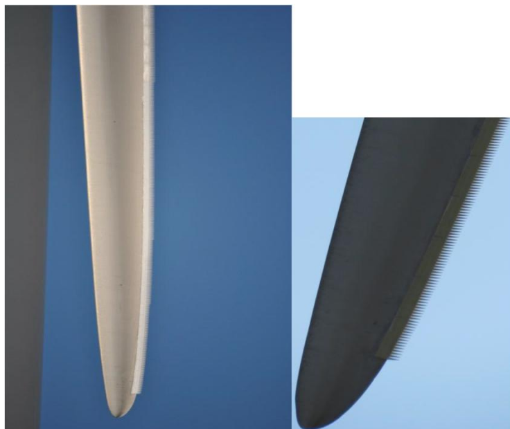
Illustrations du montage des peignes sur les pales d'une éolienne (source VESTAS)
